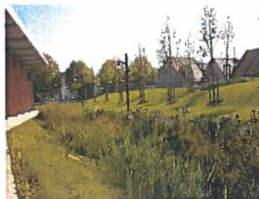
Figure 2 : Exemple de noue d'infiltration n°2
