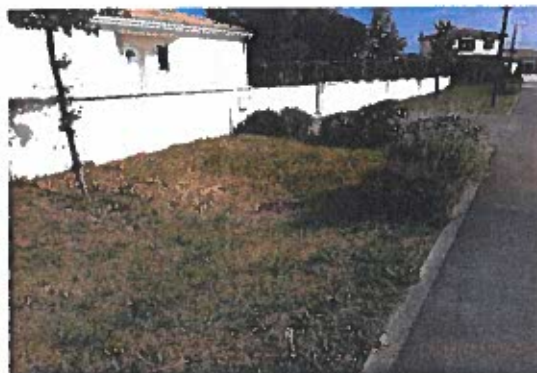
Figure 1 : Exemple de noue d'infiltration n°1
